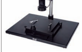
X-Y metal tabla (dahil) (X-Y hareketi: 100×86mm)
