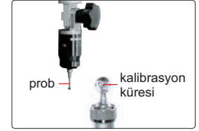
prob (opsiyonel), şunları içerir Ø2mm ve Ø3mm prob ucu, Ø25mm kalibrasyon topu, ölçüm hassasiyeti 10µm'dir
