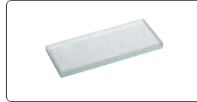
50mm okuma skalası (büyütme hassasiyeti kontrol edilir)
