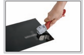
adım 1: yüzey üzerine izgara kesimi uygulama
